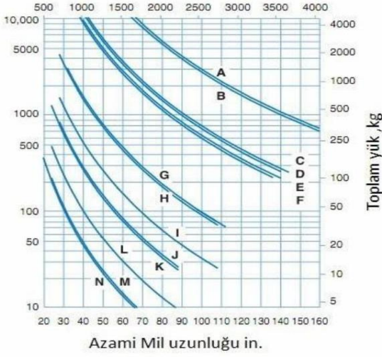
İki Rulman Destekli Müsaade edilebilir sapma 2,5 mm (0,1 in) Azami Mil uzunluğu mm
